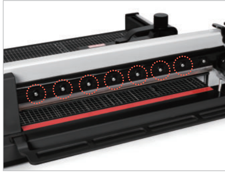
② 손잡이를 끝까지 들어올린 상태에서 8개의 나사 중 오른쪽 끝에 있는 1개의 나사만 제외 하고 나머지 7개의 나사를 모두 풀어줍니다.
