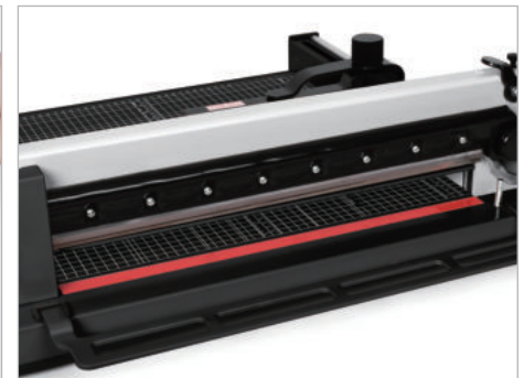
④ 드라이버를 이용하여 재단목을 들어올려 빼준 후 사용하지 않은 면으로 바뀌어서 교체해줍니다.
