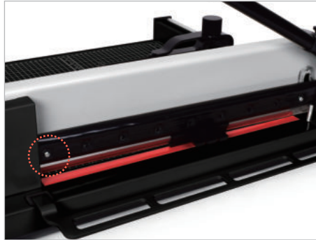
③ 페이퍼 가이드에 있는 TOOL BOX 뚜껑을 이용하여 칼날 아래를 받쳐주면서 손잡이를 내려줍니다. (가려져 있던 왼쪽의 나사 1개가 더 보입니다.)
